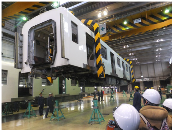
クレーンでの車両の吊り上げを見学する参加者
